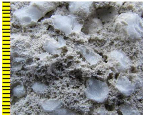
Рисунок 5. Структура композита комплексной поризации
