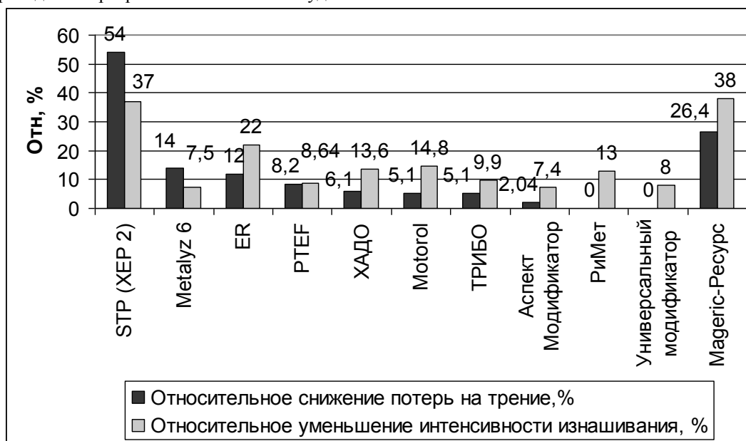
Рис. 1. Эффективность по снижению трения и изнашивания для типичных трибологических составов, распространенных на отечественном рынке присадок-добавок.
