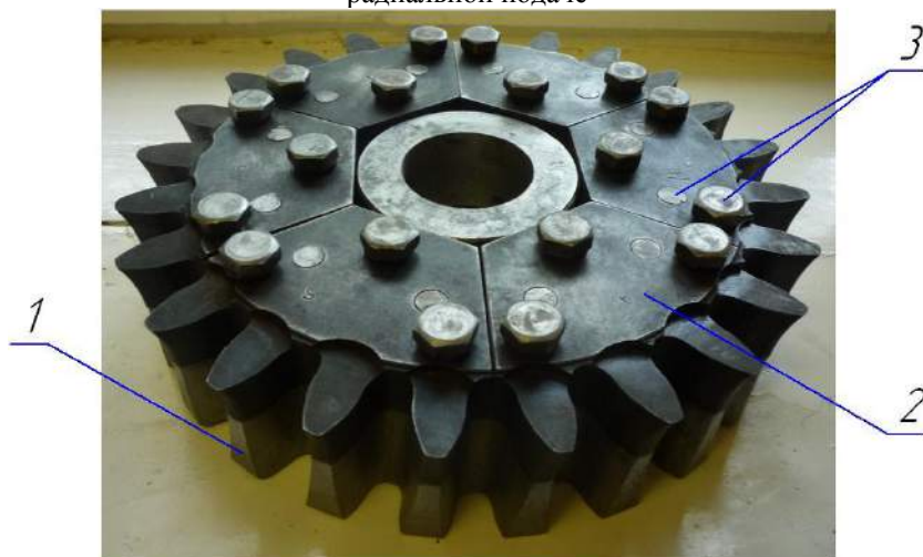
Рисунок 4 – Многолезвийный инструмент для ротационного точения: 1 – корпус; 2 – режущий элемент; 3 – элементы крепления
